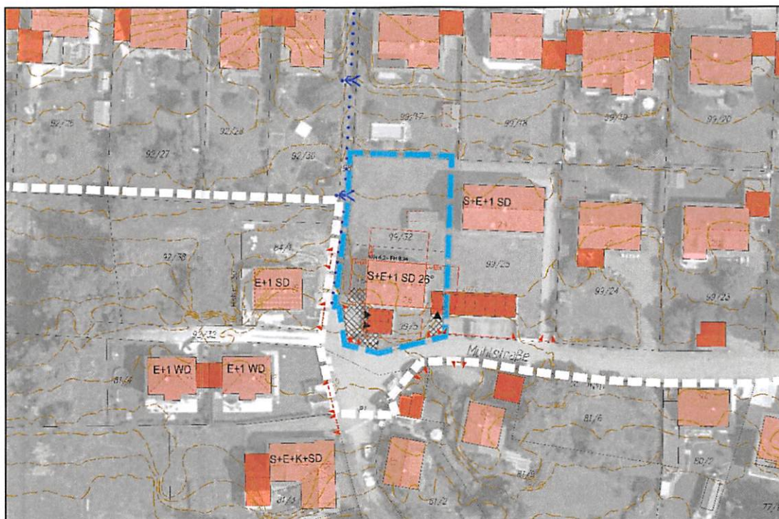
Abb. 3: Bestand mit digitalem Orthophoto DOP20 vom 01.08.2020 Änderungsbereich (cyan), Wohnnutzung (hellrot), Garagennutzung (rot), Plangrundlage: Geodatenbasis © Bayerische Vermessungsverwaltung Natürlich Grundlagen
